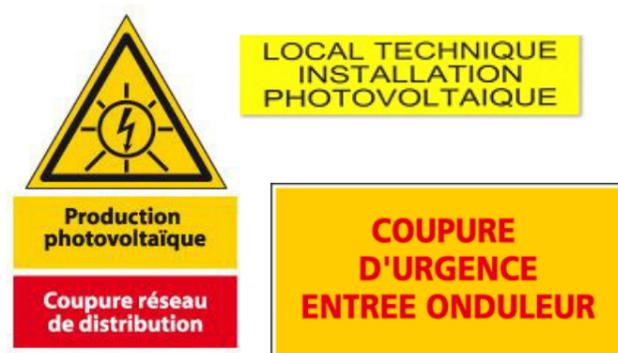
Figure 212 : Exemples de signalisation sur une installation photovoltaïque
